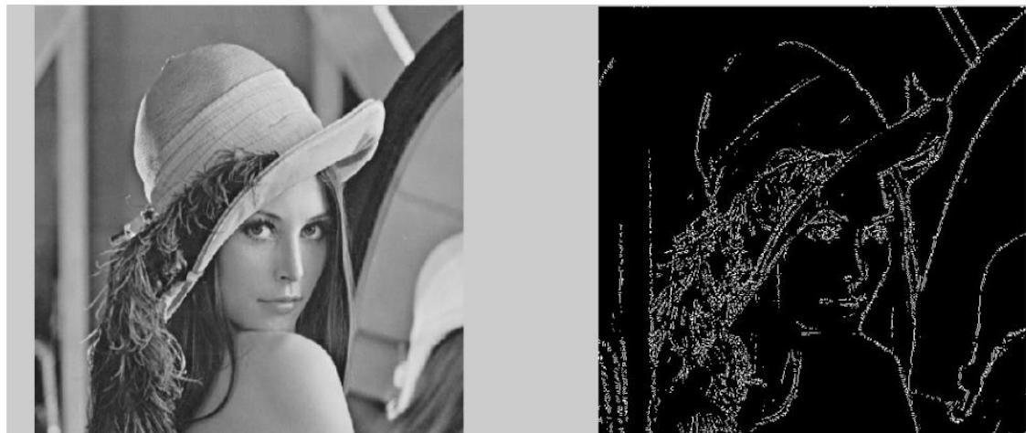
Εικόνα 6: Αποτέλεσμα συνέλιξης με φίλτρο αναγνώρισης ακμών
